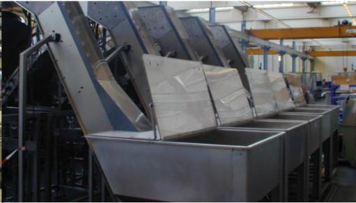
Foto: Beschickungseinrichtung für Scheibensortierer
