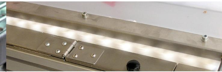
Foto: Orientierte Verschlussführung zur Montagemaschine
