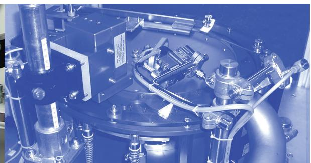
Foto: Prüfung und Aussortierung fehlerhafter Verschlüsse
